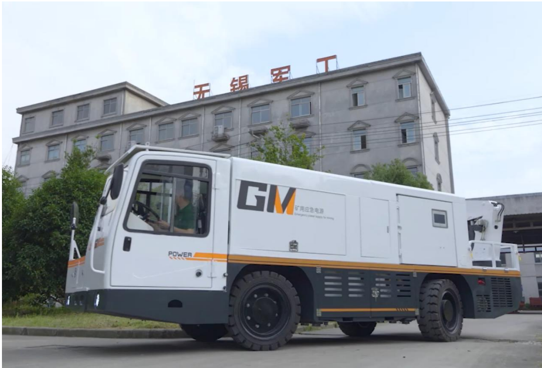
图 2 新能源应急电源装置厂区测试图
