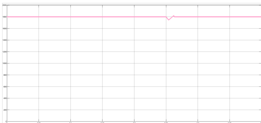
图 16 仿真验证：直流侧负载突变直流母线电压
